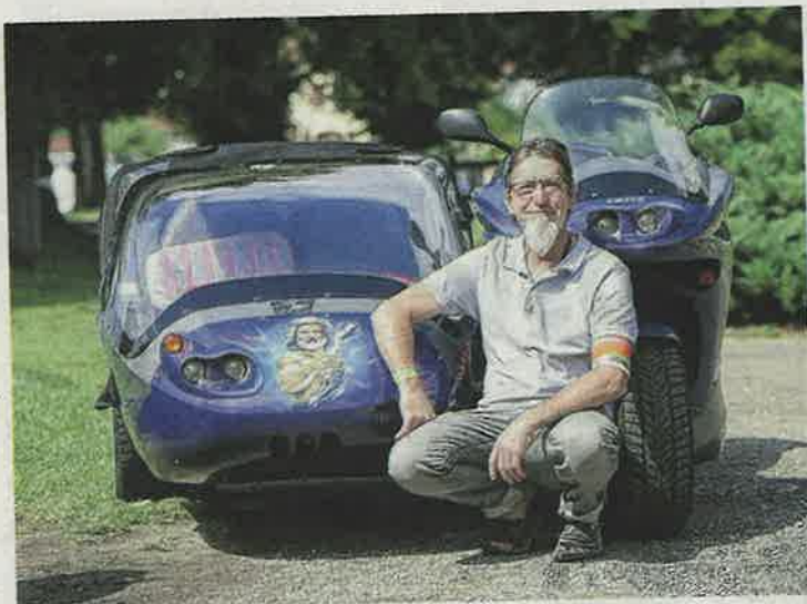
Bernard Coponat et son side 100 % français. Ce modèle Zeus 2000 cm 3 est équipé d'un moteur de 206 Peugeot.
