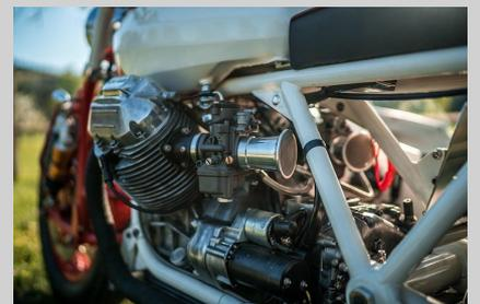
Le moteur a été poli, la boîte à air supprimée et les câbles dissimulés sous le réservoir et la selle.
