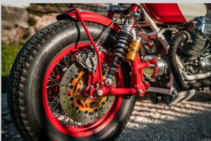
Le train avant de style Earles est équipé de suspensions Öhlins et d'un freinage Brembo.
