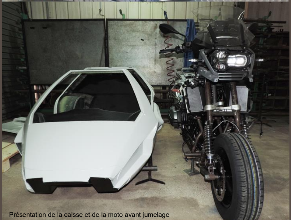
Châssis prêt à recevoir la caisse
