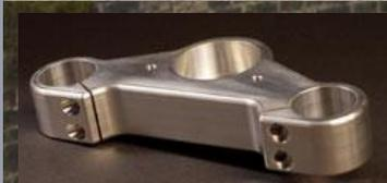
Le secret de l'agrément de conduite de cet attelage, le té de fourche DDR® permettant de loger le mécanisme réducteur de déport au sol.
