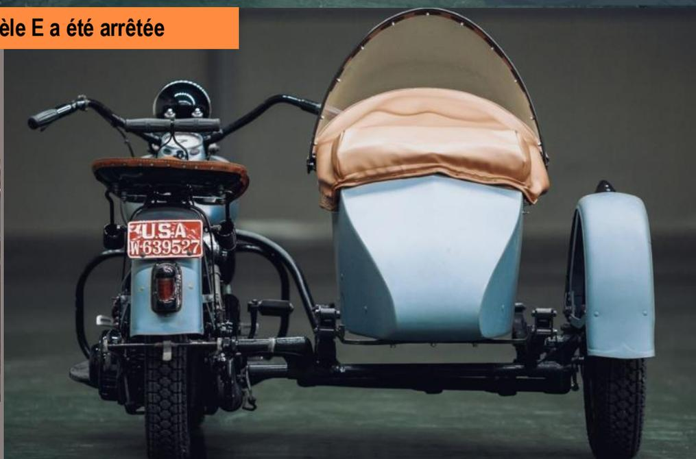
En 1938, la production du modèle E a été arrêtée, les modèles EL et ES restants ont été encore améliorés. Pour la première fois, le mécanisme de soupape a été complètement fermé, éliminant les pertes d'huile sur la route. Le cadre a été encore renforcé, la fourche de la fusée d'essieu améliorée et des changements ont également affecté l'embrayage et la transmission. De plus, la hauteur du volant a été augmentée.
