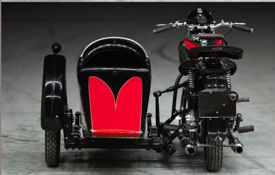
vitesse maximale 160km/h, poids 197kg, réservoir 23l..
