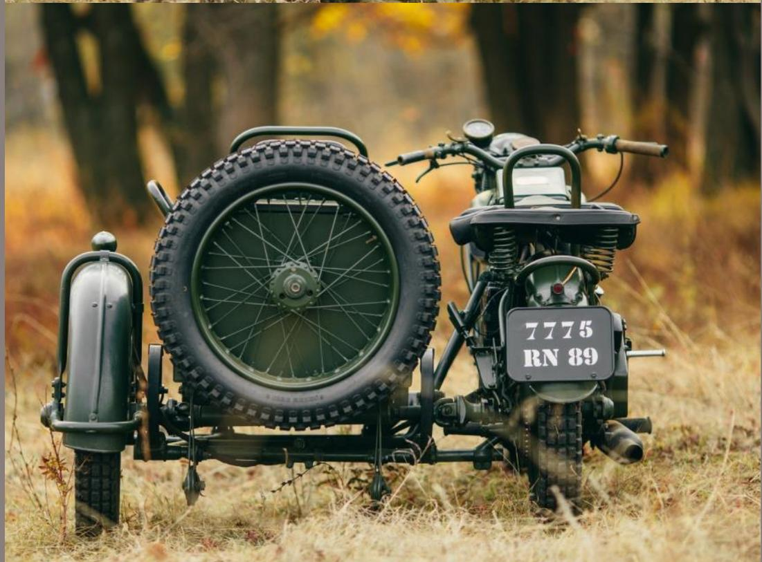
1 cylindre 633cc, 308kg, réservoir 14l., vitesse maximale 90km/h
