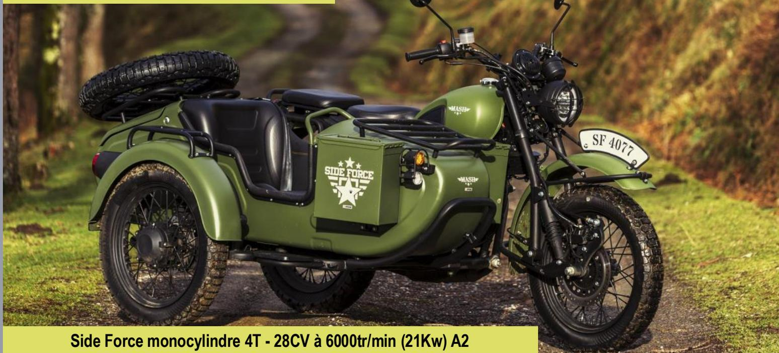
Side Force monocylindre 4T - 28CV à 6000tr/min (21Kw) A2
