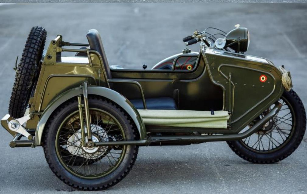
bi-cylindre 992<sup>cc</sup>, 485kg, réservoir 19l., vitesse maximale 90km/h
