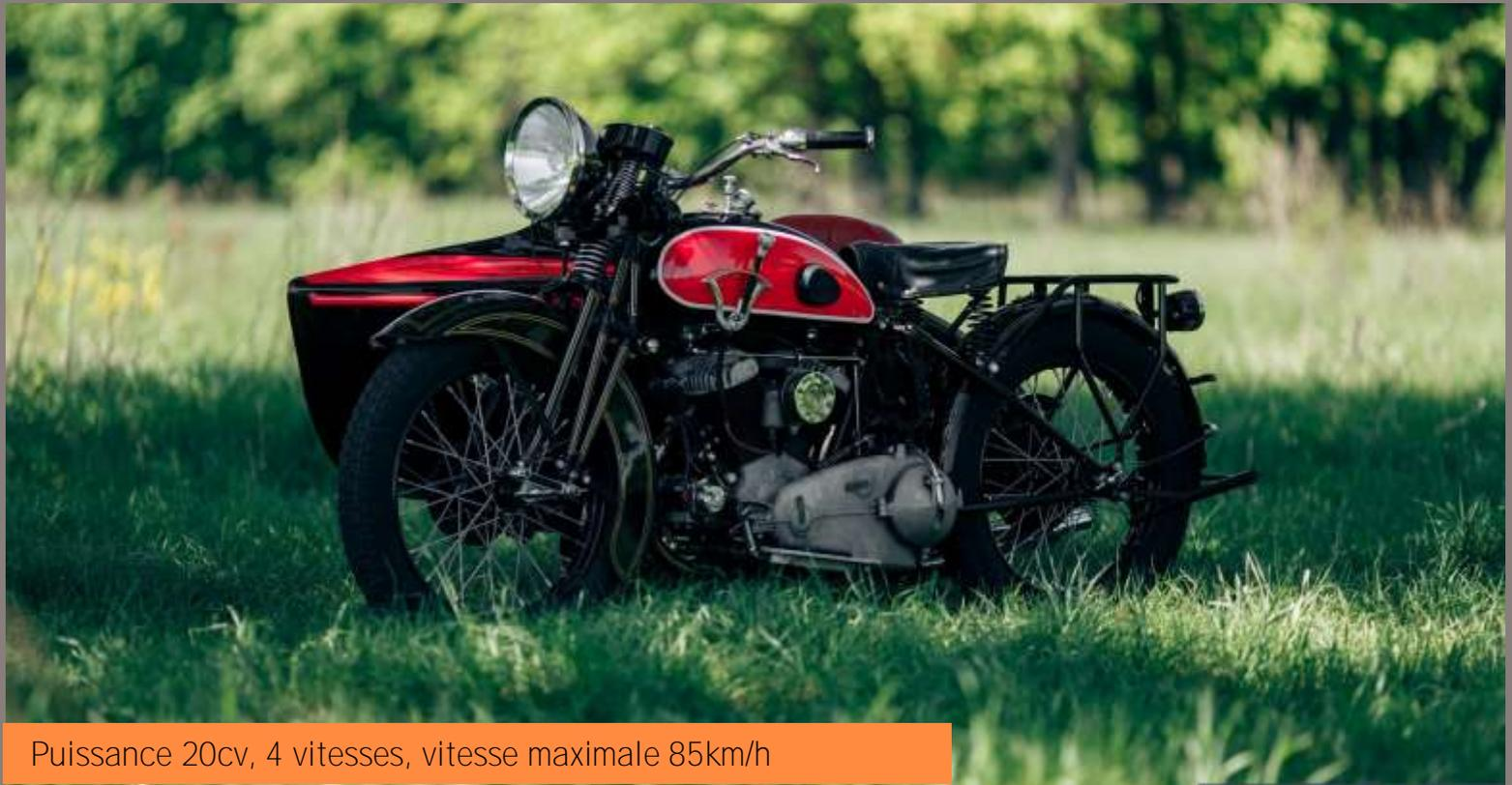
Puissance 20cv, 4 vitesses, vitesse maximale 85km/h
