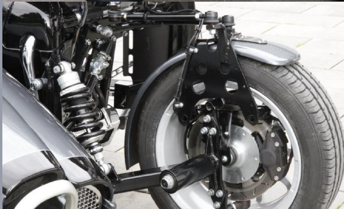
Le mouvement de direction du guidon est transféré directement à la roue avec une jambe de force, 2 nouveaux disques de frein moto en acier inoxydable et 2 nouveaux étriers de frein Brembo font partie de l'équipement standard.
